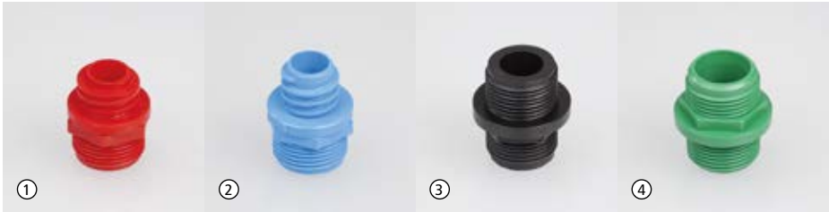
① Gewindeadapter 3/4" - Hünersdorff ② Gewindeadapter 3/4" - Kautex ③ Gewindeadapter 3/4" - zylindrisches G 3/4" Fassgewinde ④ Gewindeadapter 3/4" - konisches R 3/4" Fassgewinde
