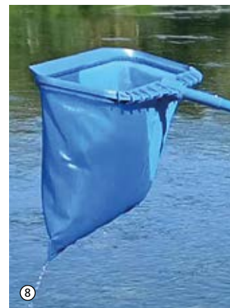
Kescher zur Probenahme von Feststoffen und Organismen aus Gewässern.
